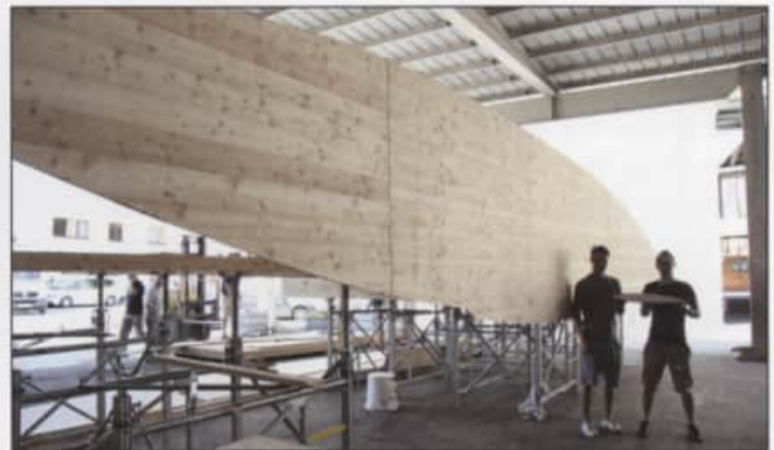
Die Bordwände bereits zusammengesetzt und aufgestellt. Die Bootsbauer mit der Modellschablone.
