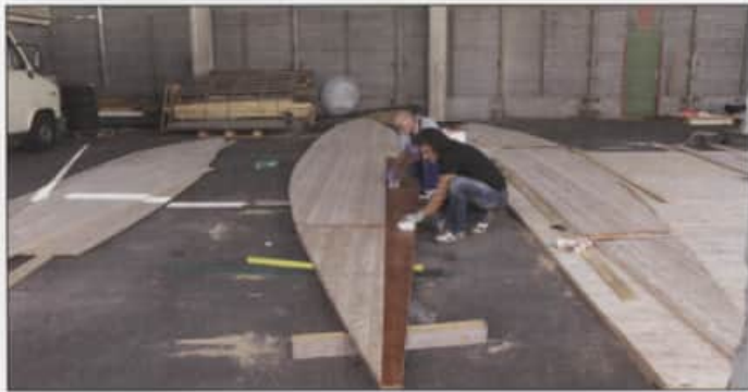
Auf dem Mallboden werden die Bordwände angerissen und ausgeschnitten. Verwendung finden je 2 x 19 mm verleimte Lärchenplatten von der Tilly Holzindustrie Althofen.
