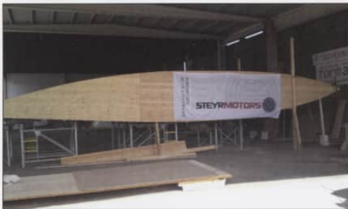
Die Bordwände bereits zusammengesetzt und aufgestellt. Die Bootsbauer mit der Modellschablone.
