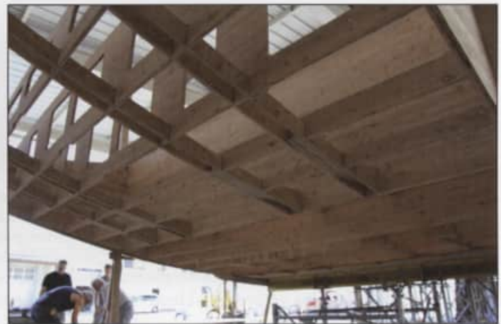
Spanten und Träger beim Blick von unten in den Rumpf.
