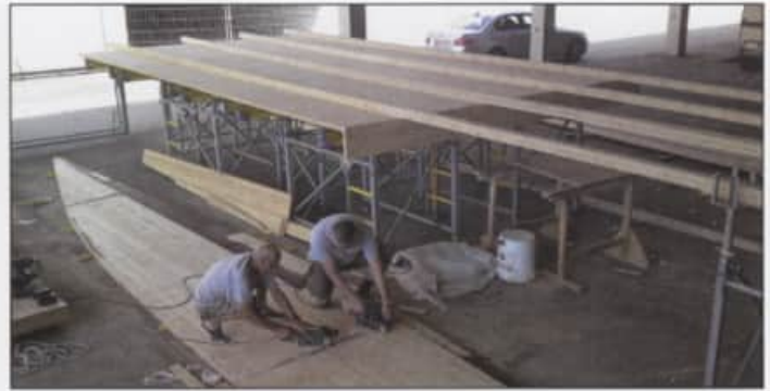
Auf dem Mallboden werden die Bordwände angerissen und ausgeschnitten. Verwendung finden je 2 x 19 mm verleimte Lärchenplatten von der Tilly Holzindustrie Althofen.
