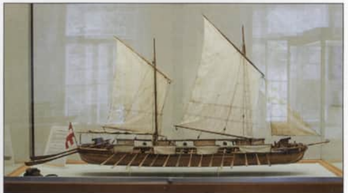
Zeitgenössisches Modell (1819) einer Canonier-Barquen mit, 15 Ruderpaaren, 6 Gabelstücken und je einem Bug und Heckgeschütz auf Drehlafette. Die Restaurierung des beschädigten Modells erfolgte durch Prof. Kurt Schaefer.
