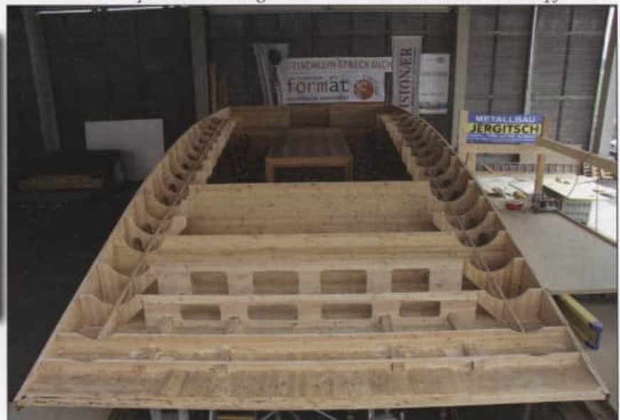
Spanten und Träger beim Blick von unten in den Rumpf.
