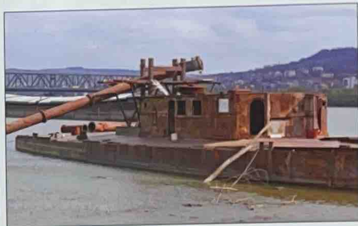
Gut sichtbar das Rohr für den Schüttgut-Transport mit Auflage. Kennung P 925 A. Foto Milena Djordjevic
