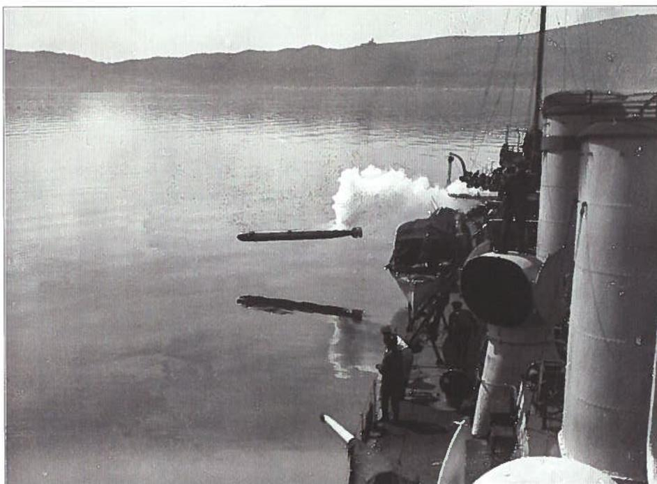
*Torpedoübung des Torpedofahrzeuges DUKLA am 25. April 1918. Torpedos wurden regelmäßig gewartet und auch durch Abschussübungen der richtige Lauf nach Kurs und Tiefeneinstellung im Wasser nachgewiesen. Die Dampffahne rührt von der Beheizung des Druckluftbehälters her.*
