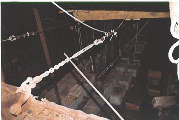
Blick in die Bilge. Betonblöcke als Ballast und die Strecktaue, die die Lasten der Wanten abfangen. Foto: Klein
