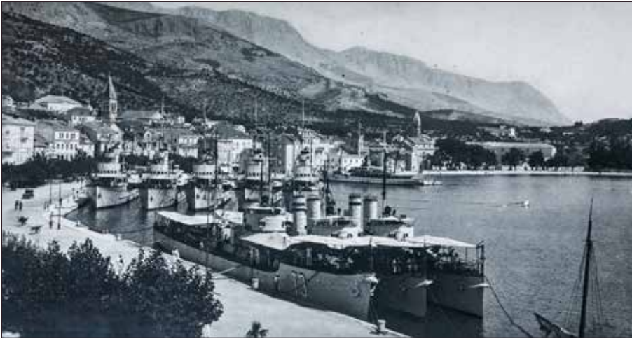
Im Vordergrund T 3 ( ex Tb 78 T) mit 1 Kamin ehemals rechts davon 2 Boote F-Typ. Die jugoslawische Marine behielt die Kennzeichnung mit Kaminringen bei.
