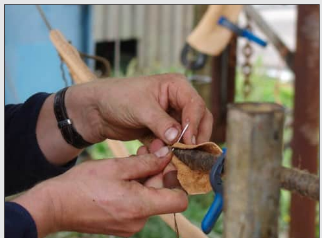
Abschließend erfolgt das Einnähen in einen Lederstreifen.
