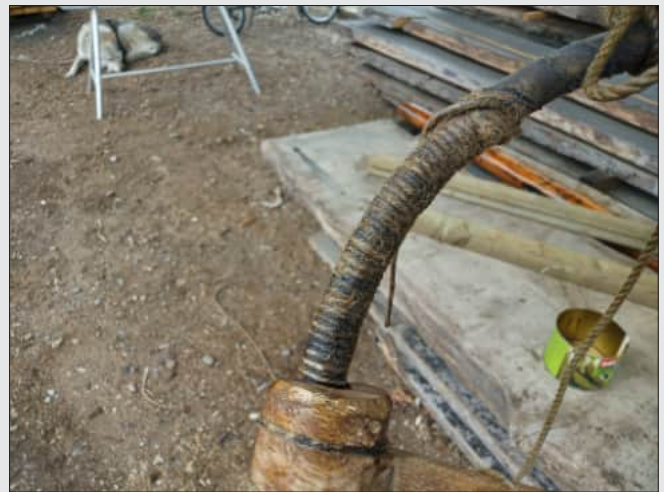
Mit der Kleedkeule (teilweise am unteren Bildrand sichtbar) wird unter ständiger Spannung eine dicht gewickelte Schnur-Bekleidung hergestellt.
