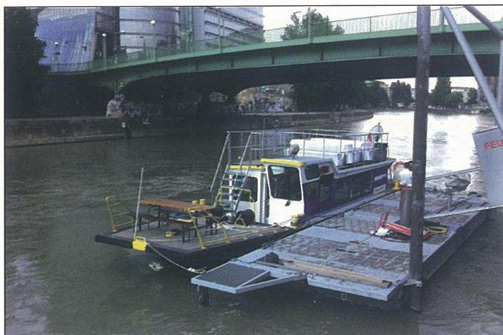
Das MESSSCHIFF 4 der via donau nach Umbau zum »Bereisungsschiff«. Die früher sehr voluminösen Mess- und Auswertungsgeräte wurden durch moderne Messinstrumente, die in einem Handkoffer Platz finden, ersetzt. Das Bereisungsschiff wurde im Zuge der Hahn-Reise erstmals eingesetzt. Foto R.C. Tögel.
